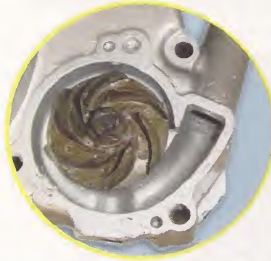
Vista interior de la bomba de agua
